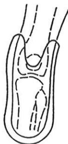
Les murs latéraux entourent la rotule et forment deux ailes condyliennes moulées sur le fémur assurant la parfaite stabilité latérale. Cette stabilité est renforcée :
