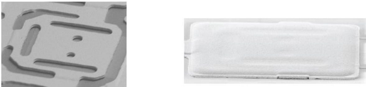
Figure 1-13- Photographie au microscope à balayage électronique de la capacité commutée MEMS développée par XLIM (a) avant et (b) après encapsulation.
