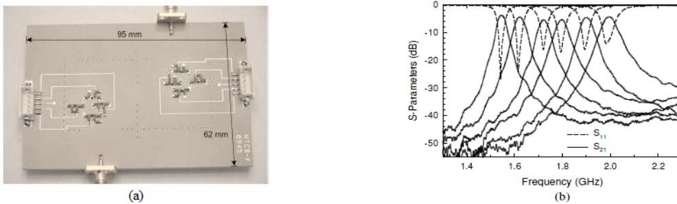
Figure I- 33 : (a) Filtre SIW accordable avec une diode PIN (b) réponse de la filtre après mesure
