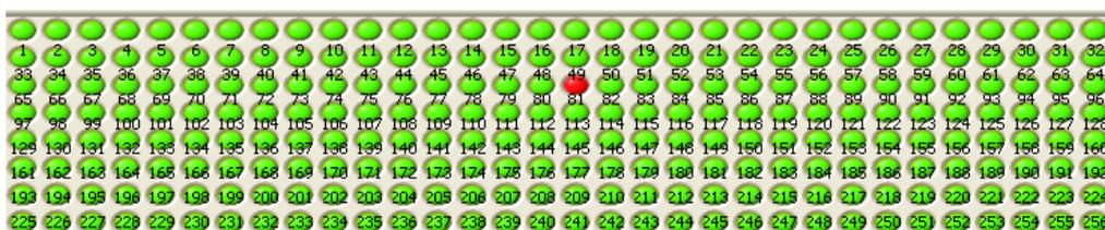
Figure II- 4 : Mosaïque de l'éjection de l'encre Ag à 300µs avec la tête d'impression
