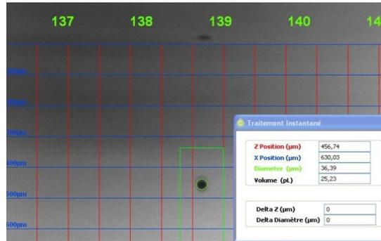
Figure II- 5.b1 : Volume de goutte estimé en vol à
