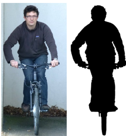
Figure 2-9 : mesure de la surface frontale par technique photographique.
