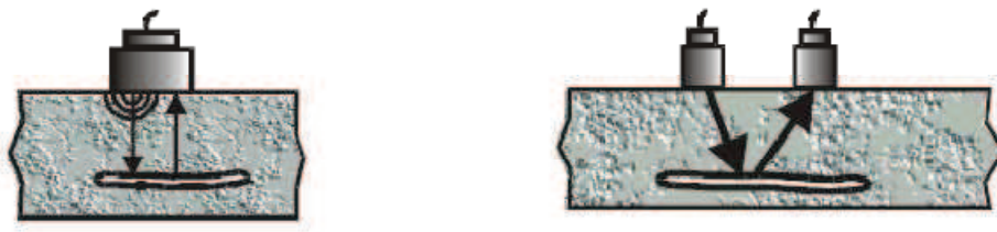
Figure I. 8 : Exemple d'application du calcul du temps de parcours de l'onde entre l'impulsion et la réception [Garbacz, 2003]
