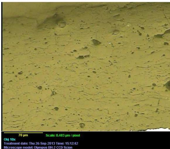
Microestructura 2HP Acero 316L
