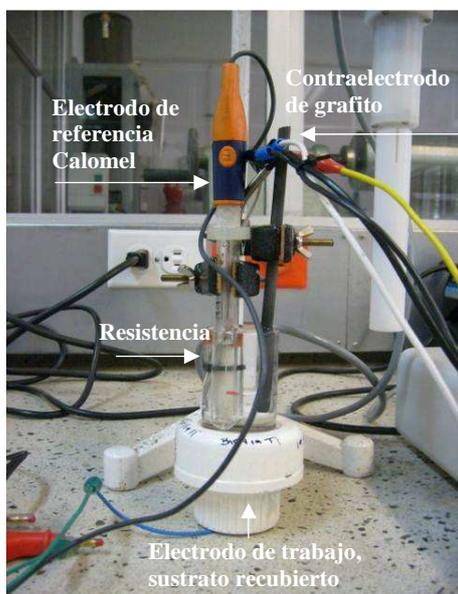
a) Montaje utilizado para realizar los ensayos electroquímicos
