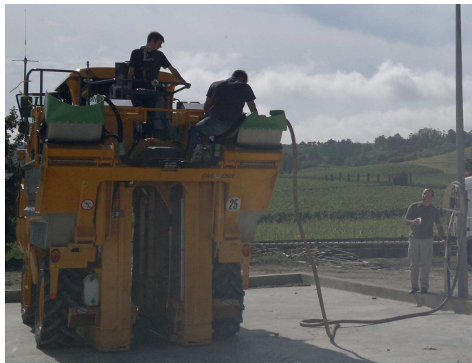
FIGURE 4.4 – Remplissage des bennes du tracteur G7 GREGOIRE pour réaliser des essais avec charge.
