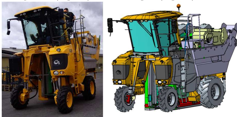
FIGURE 2.4 – Vue en 3D du tracteur porteur vendangeur G7. Machine réelle (à gauche) et modèle CAO (à droite)
