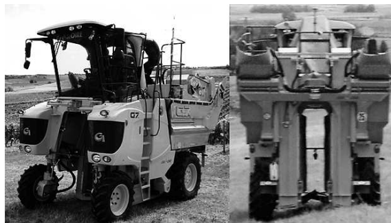
FIGURE 1.1 – Machine à vendanger de la société GREGOIRE, partenaire du projet (à gauche : vue de profil, à droite : vue arrière avec compensation de dévers actif)
