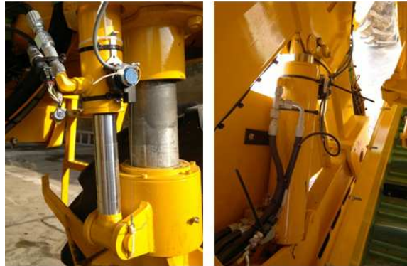
FIGURE 4.7 – Le potentiomètre à câble installé sur le vérin avant gauche (image à gauche) et celui installé sur le vérin arrière droit (image à droite).
