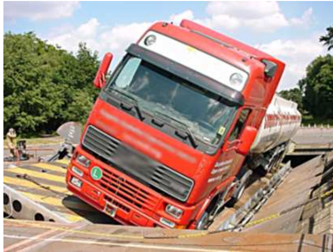
FIGURE 1.5 – Dispositif expérimental de mesure du Tilt Table Ratio
