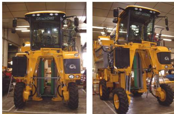
FIGURE 4.8 – Configurations internes extrêmes : position basse (à gauche) et position haute (à droite).
