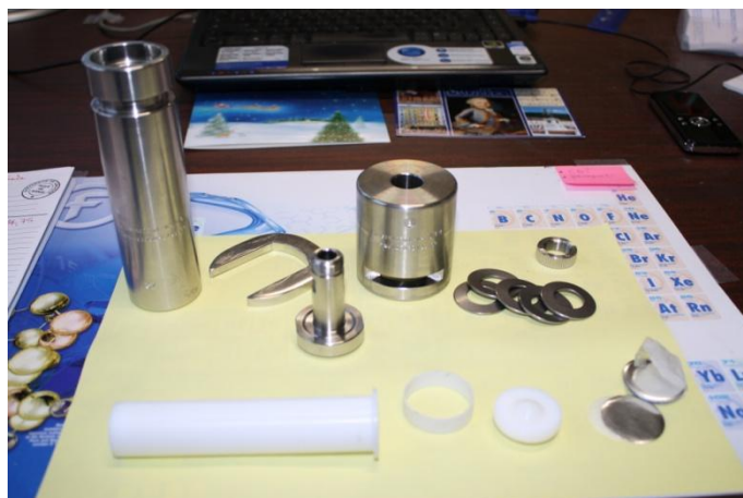
Figure 31 : Autoclave et réacteur en téflon® utilisés au laboratoire dans le cas des synthèses solvothermales.
