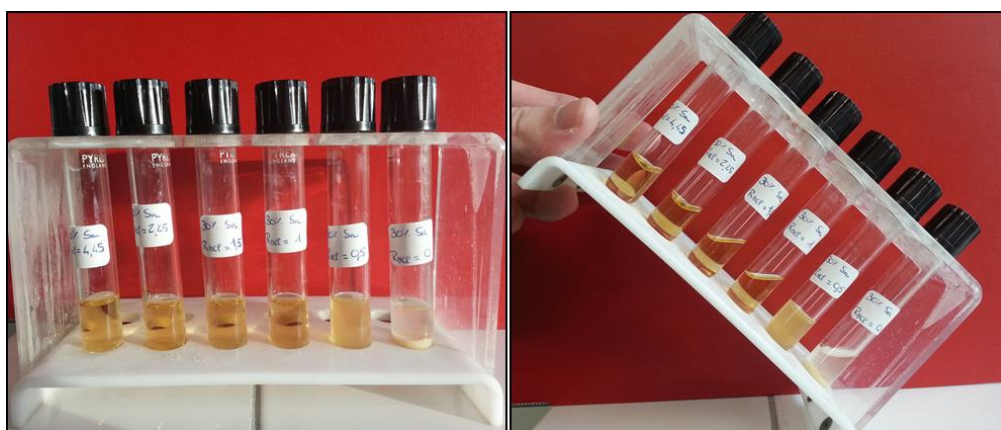
Figure 17 : sols mixtes contenant 30 % d'étain préparés avec différent ratio d'acide chlorhydrique ( R_{\text{HCl}} = 4,45 ; 2,25 ; 1,5 ; 1 ; 0,5 et 0 de gauche à droite) par rapport à l'alcoxyde d'étain et leur état après un mois passé dans l'étuve à 60 °C.
