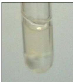
Figure 3 : gel précurseur d'oxyde d'étain élaboré avec les paramètres de référence.
