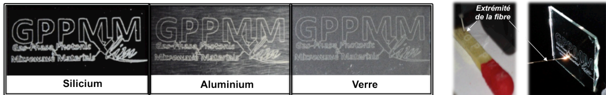
Figure IV.9 : Micro-usinages par faisceau transmis le long de 10 m de fibre Kagomé 19-cell sur différents matériaux.
