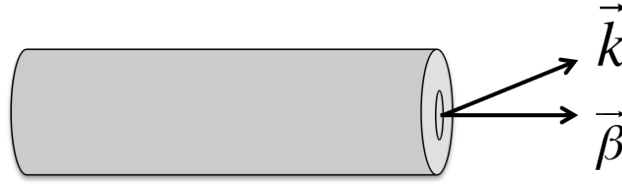
Figure II.1 : Représentation schématique de la constante de propagation \beta et du vecteur d'onde k dans une fibre à BIP à cœur creux.
