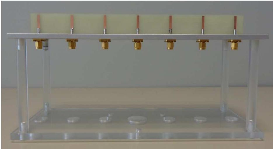
*Figure III-16 : Le réseau de monopôles est maintenu par un support en polycarbonate. Chaque monopôle est relié à un connecteur SMA*
