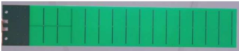
Figure IV-25 : L'antenne à 15 éléments réalisée sur le substrat à 4 couches est mesurée dans la base de mesure d'antennes d'Xlim
