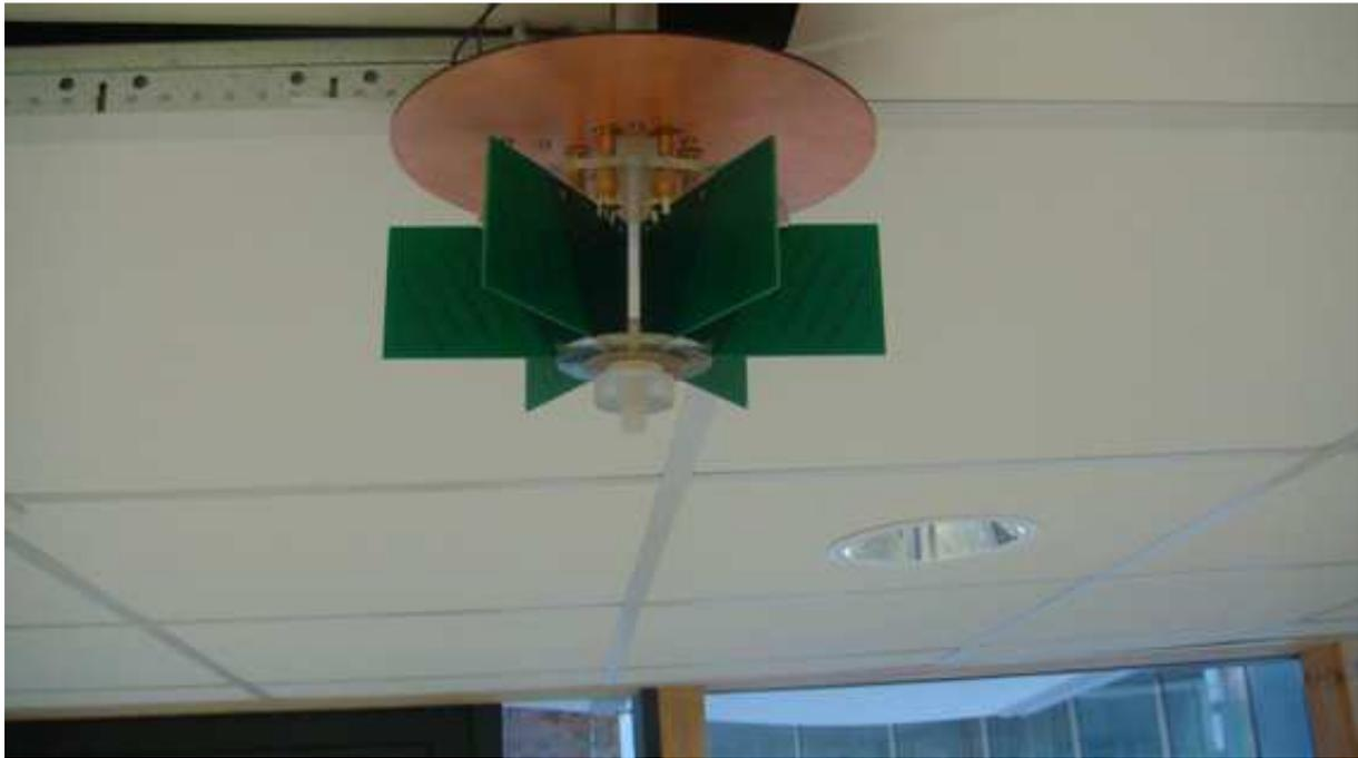
*Figure V-45 : Prototype réalisé du plafonnier complet installé dans les locaux d'XLIM pour test*
