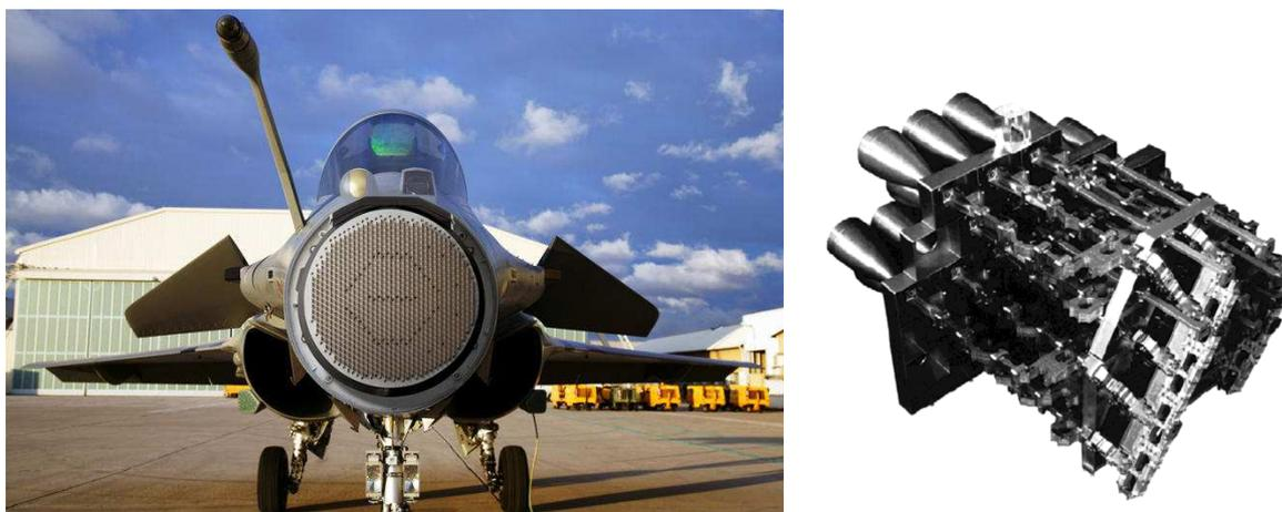
Figure I-5 : DRA actif pour le Radar rafale C137\_RBE2 [12](à gauche) et circuit de formation de faisceaux en guides d'ondes pour applications multifaisceaux spatial [13]
