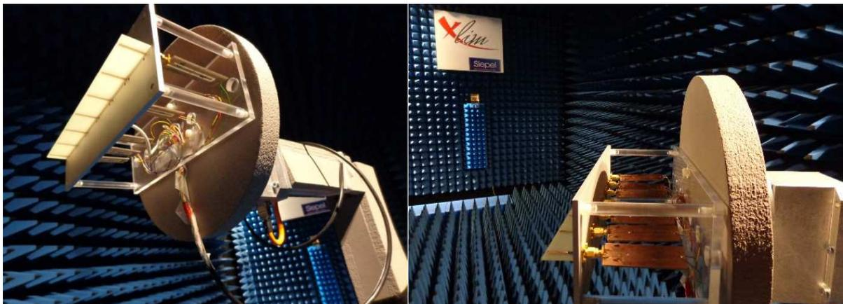
Figure III-29 : Antenne sous test dans la chambre anéchoïque (base de mesure d'XLIM)
