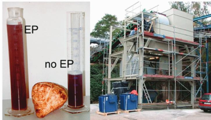
Figure 1.20 – À droite : comparaison des résultats de l'extraction du jus sucré de betteraves par électroporation irréversible et par la technique d'extraction traditionnelle. À gauche : l'installation industrielle utilisée pour le traitement des betteraves par électroporation. D'après [56].
