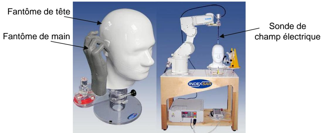
Figure 3.3 – Banc de test pour la quantification du SAR local engendré par un téléphone mobile collé à l'oreille de l'utilisateur<sup>4</sup>.
