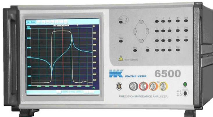
**Figure 26:** Analyseur d'impédance utilisé pour les premières caractérisations
