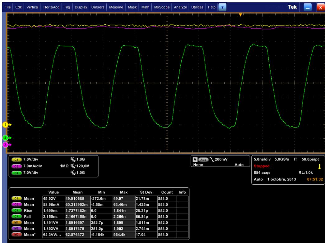
**Figure 195:** Tension de sortie de la cellule de commutation monolithique sous 30V pour une fréquence de découpage de 100MHz (Source III-V Lab)
