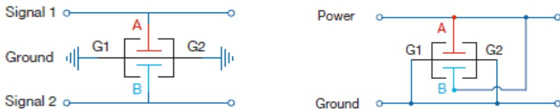
**Figure 51:** Utilisation d'un condensateur X2Y en filtrage (à gauche) ou en découplage (à droite)
