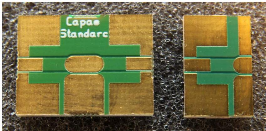
**Figure 27:** Circuit imprimé de caractérisation des condensateurs (à gauche) et circuit d'étalonnage pour deembedding (à droite)
