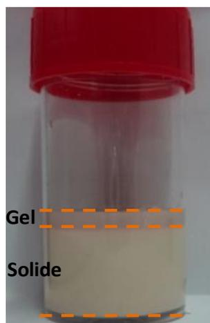
**Figure 11** : photographie de l'échantillon  $MI S_{100}$  composé d'une phase solide et d'un gel.
