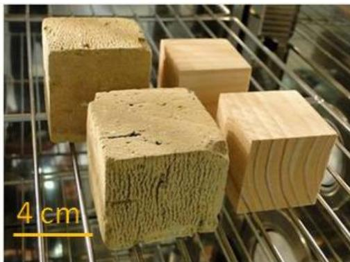
**Figure 12** : dispositif du test de sorption hygroscopique et photo des échantillons à l'intérieur de l'enceinte climatique.
