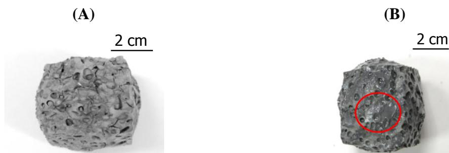
**Figure 12 :** (A) échantillon mousse standard sec et (B) après un passage à une humidité relative de 80% (en rouge une zone de suintement).
