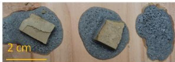
**Figure 3** : test de collage avec la mousse standard pour une observation visuelle.
