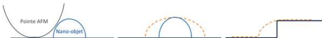
Figure 2.11 : schémas de l'effet de la taille de la pointe (convolution de pointe) sur la représentation d'un nano-îlot et d'une marche nanométrique. La trajectoire mesurée par la pointe est représentée en pointillés [5].
