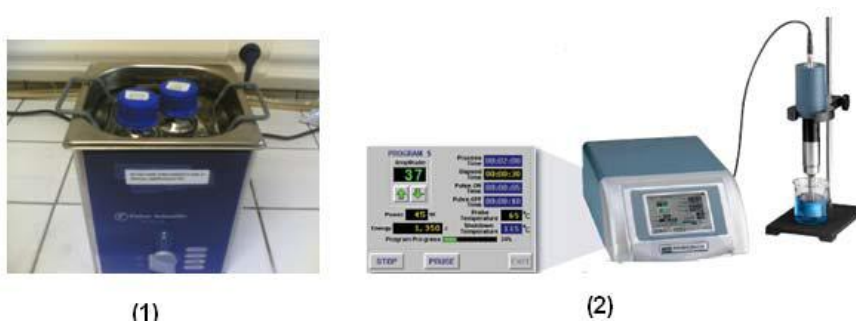
Figure 97: Techniques de dispersion des NTC utilisées au laboratoire : 1) bac à ultrasons ; 2) sonde à ultrasons
