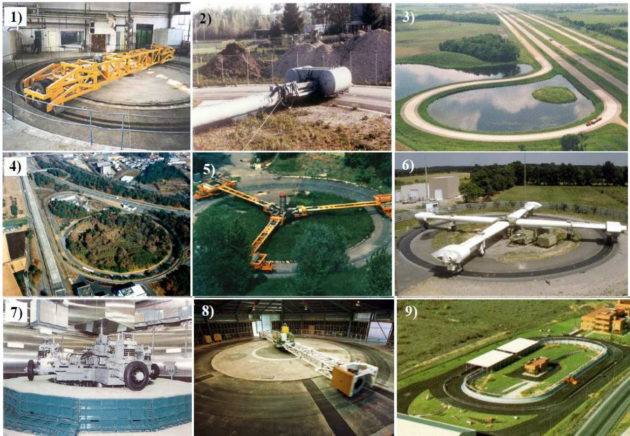
FIGURE 1.30. Simulateurs de trafic lourd circulaires : 1) Roumanie, 2) Suisse, 3) Etats-Unis (Minnesota), 4) Japon, 5) Slovaquie, 6) France, 7) Japon, 8) Nouvelle Zélande, 9) Espagne
