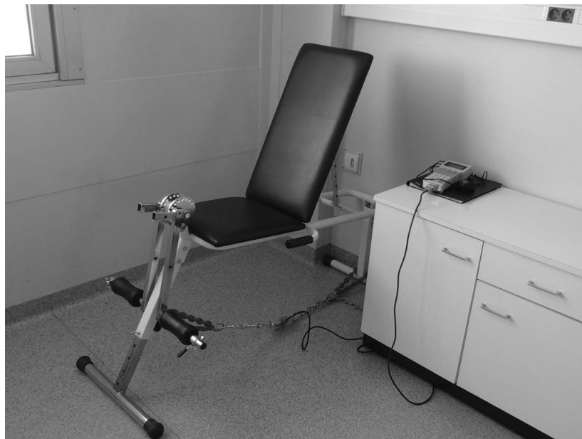
Figure 23 : Banc isométrique avec capteur de force
