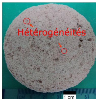
FIGURE 4.7 – Coupe d'une mousse crue séchée à 70 °C, réalisée à partir de la méthode d'élaboration n°1
