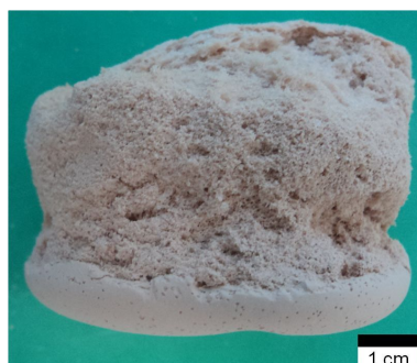
FIGURE 4.10 – Exemple d'une mousse consolidée, fabriquée à partir d'une suspension de kaolin trop fluide
