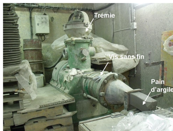
FIGURE A.3 – Extrudeuse. Sortie et conditionnement de la pâte argileuse GT 100P
