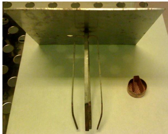
Figure II-4 : Griffes et panier servant à maintenir les pièces pendant leur immersion dans les différents bains d’electroless
