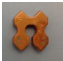
Figure II-33 : Photographie du filtre 4 pôles métallisé et avec ses motifs d'excitation gravés
