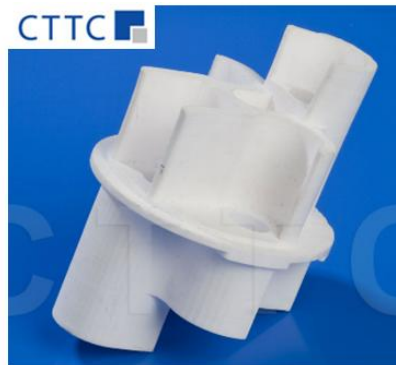
Figure A1-10 : Connecteur fabriqué en alumine par SLA 3D [II.18]
