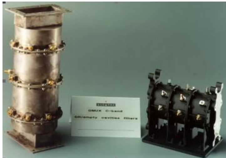
Figure I.6 : Comparaison de filtres à cavités et de filtres à résonateurs diélectriques en bande C
