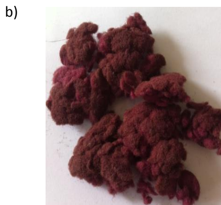
Figure 2.3.a : a) Fibres propargylée et b) Fibres après greffage de la porphyrine.
