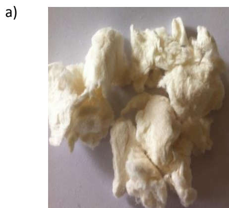
Figure 2.3.a : a) Fibres propargylée et b) Fibres après greffage de la porphyrine.
