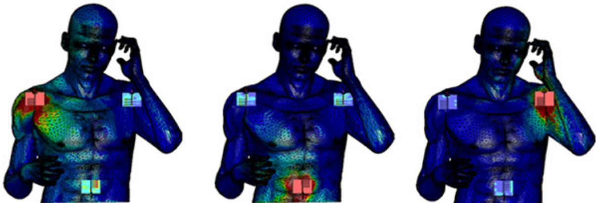
Figure IV.51 Distribution du champ de l'antenne dipôle émettrice déposée à différents endroits
