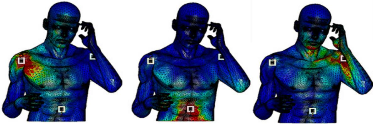
Figure IV.53 Distribution du champ de l'antenne réseau de patchs émettrice déposée à différents endroits
