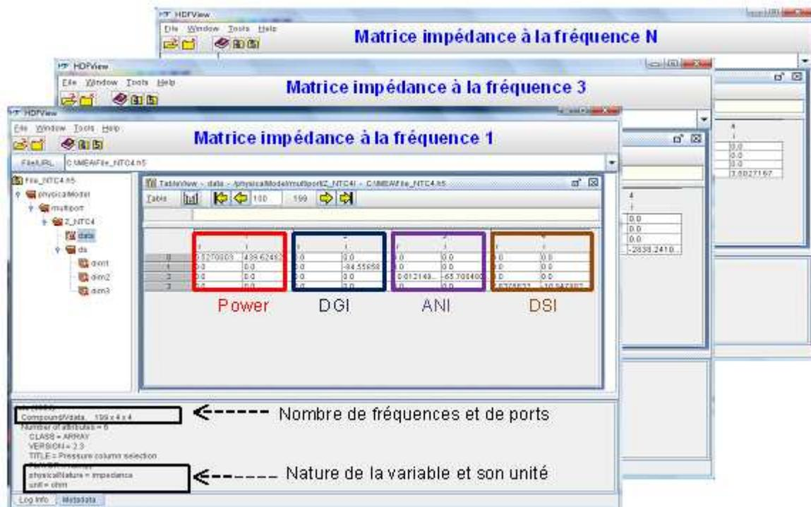
Figure II. 14 : Matrice impédance du cas test NTC4 au format Amelet-HDF
