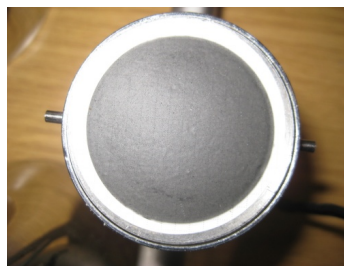
Figure 23 : photo d'un filtre obtenu après filtration de l'effluent traité au charbon actif en poudre combiné à la filtration sur sable.
