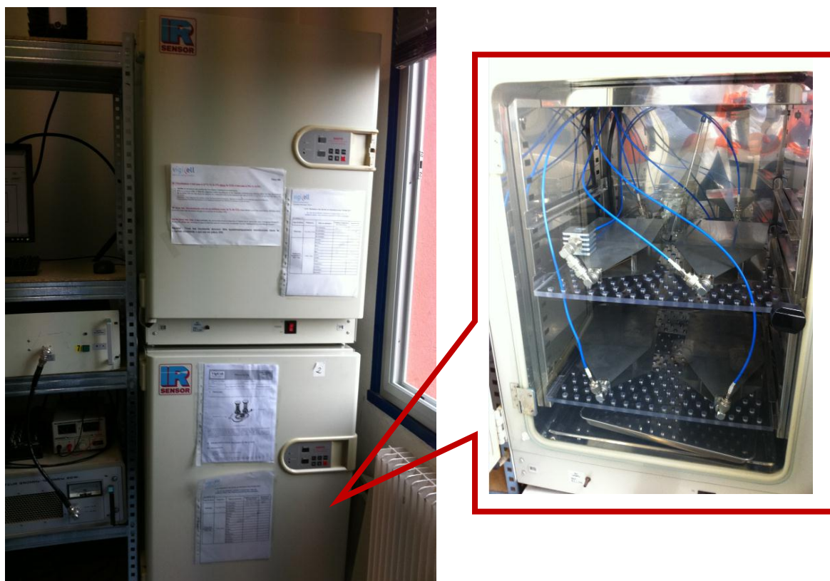
Figure 50 : Cellules TEM placées dans les incubateurs pour le système RFFIBHE.
