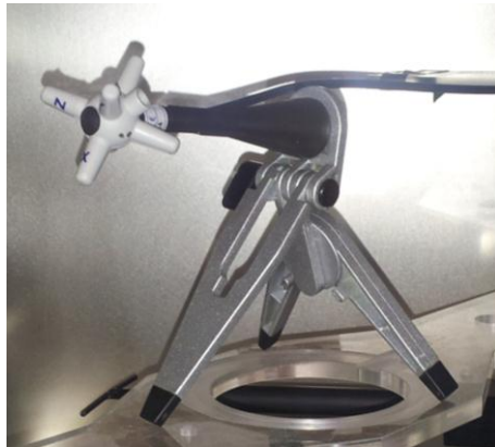
Figure 89 : Capteur de champ électrique Narda EP600 utilisé pour les mesures dans l'incubateur.
