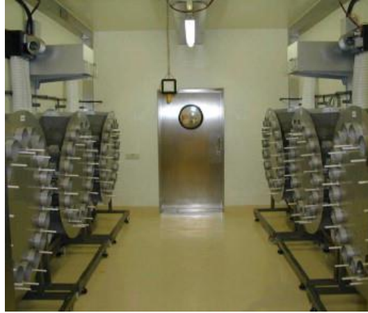
Figure 31 : Système d'exposition composé de 6 Ferris-Wheel avec chacune 17 guides d'onde sectoriels pour l'exposition "corps entier" de 17 rats [72].
