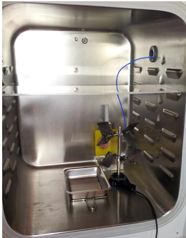
Figure 85 : Photographie du système d'exposition basé sur l'incubateur.
