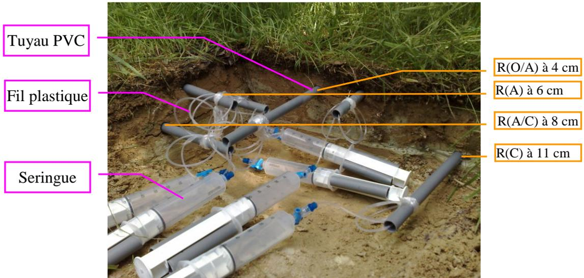
Figure II.4. Photo du dispositif de collecte des solutions du sol
