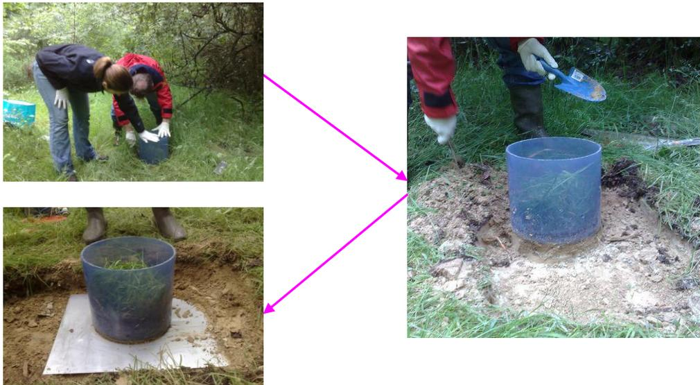
*Figure II.6. Prélèvement de colonne de sol en 3 étapes*
