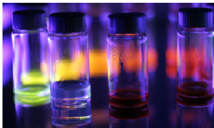
Figure 14 : Quantum dots colloïdaux de différentes tailles et natures émettant à différentes longueurs d'onde sous une même excitation optique UV.
