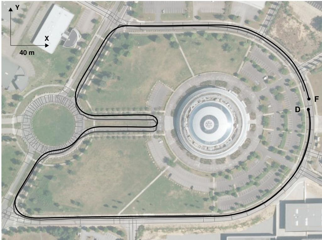
FIGURE 4.18 – Localisation obtenue par couplage serré odométrie GPS et Map Aiding (en gris foncé) - Comparaison avec la localisation fournie par le récepteur GPS (en noir - trame GGA) - Projection sur le plan  $XY$  - Rectangles gris : modélisation du réseau routier.
