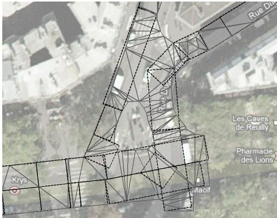
FIGURE C.3 – Modélisation de l'espace roulant par facettes triangulaires (gris) et par parallélépipèdes rectangles (noir) - Projection sur le plan XY - Maire du XIIème arrondissement.
