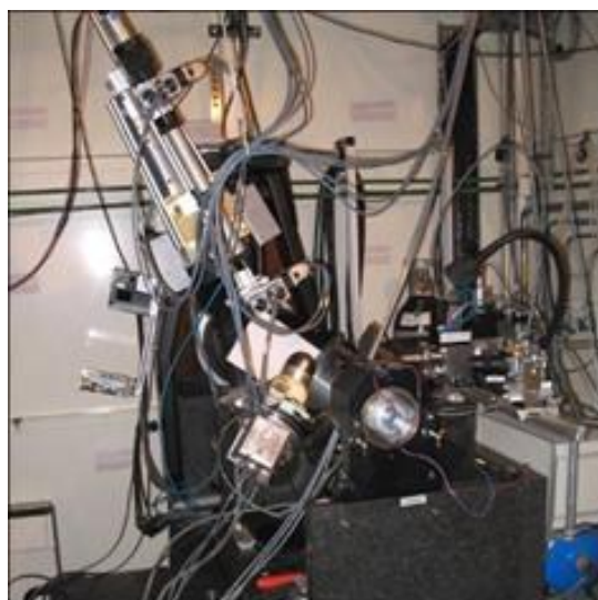
Figure 14 : le goniomètre 7-cercle utilisé [19].
