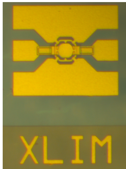
FIGURE 2.34 – Photographie optique du micro-commutateur à contact capacitif optimisé réalisé au laboratoire XLIM.
