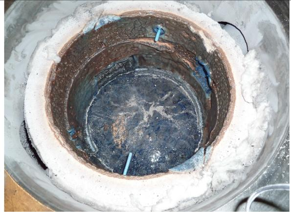
Figure IV-19 : Photographie du bain de verre à l'ouverture du four après l'essai N°11.
