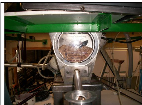
Figure III-17 : Distributeur pour les éclats carrés.
