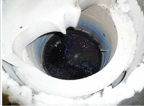
Figure III-11 : Photographie de l'intérieur du réacteur avec les doubles parois, la Zirrane, le réfractaire, le creuset et le verre.
