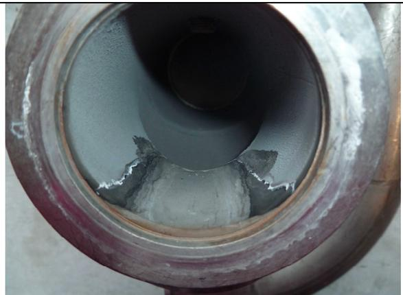
Figure IV-23 : Photographie de l'intérieur des circuits de refroidissement après l'essai N°7, avec une partie nettoyée par un passage d'eau (partie basse).
