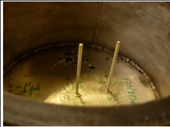
Figure III-12 : Deux thermocouples B dans le fond du creuset en acier, qui seront dans le verre.
