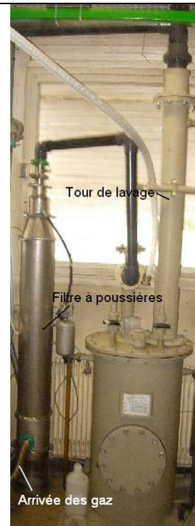
Figure III-16 : Photographie du circuit de nettoyage des gaz.
