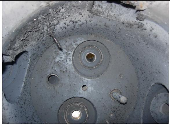
Figure IV-21 : Photographie de l'intérieur du four (vue par en dessous de la voûte) après l'essai N°4.
