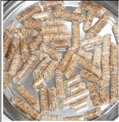
Figure I-20 : Photographie de pellets ou granulés de bois.
