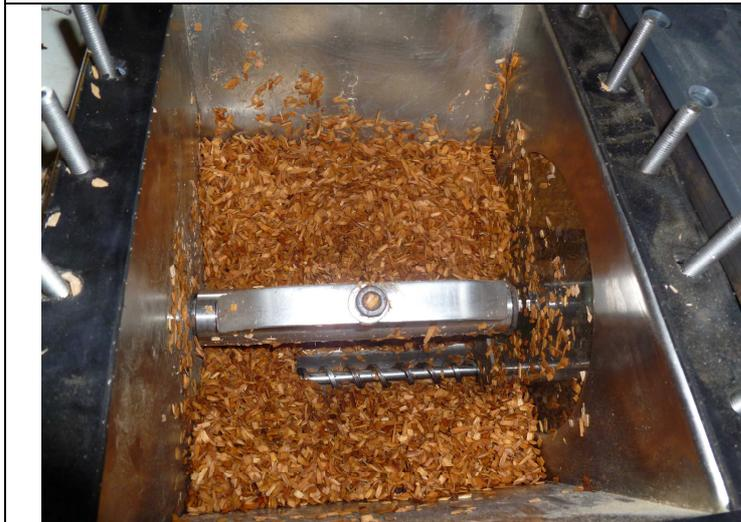
Figure III-2 : Photographie des éclats de hêtre humidifiés dans le distributeur de biomasse.
