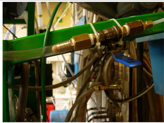
Figure III-20: Dispositif d'insertion des billes de hêtre.
