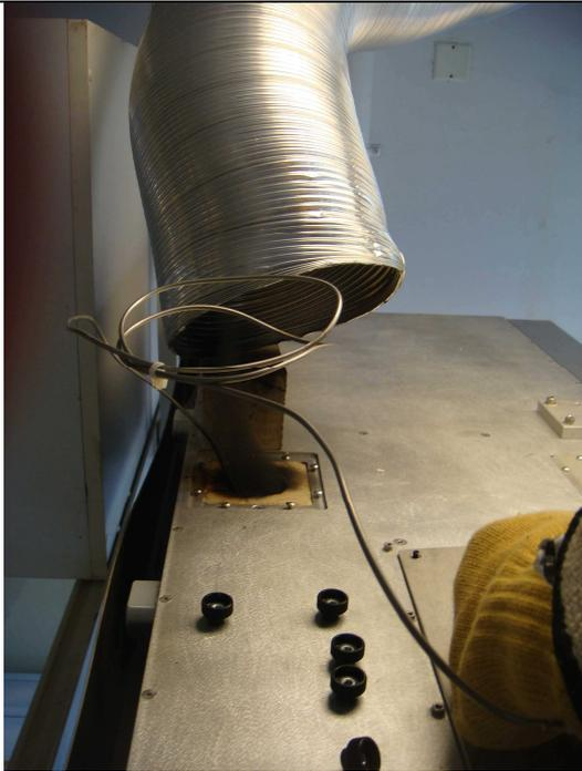
Figure IV-32 : Photographie de la sortie des gaz du dispositif ATG.
