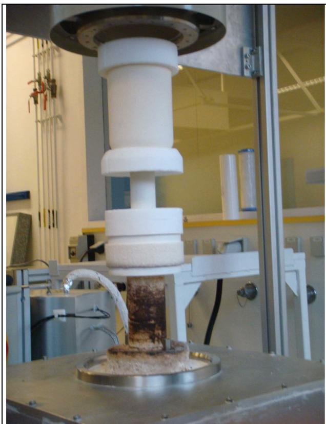
Figure III-25 : Creusets et guide une fois mis en place sur le fléau de la balance et prêts à être montés à l'intérieur du four.
