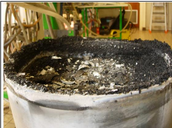
Figure IV-16 : Photographie du creuset en fin d'essai et des résidus carbonés à la surface.
