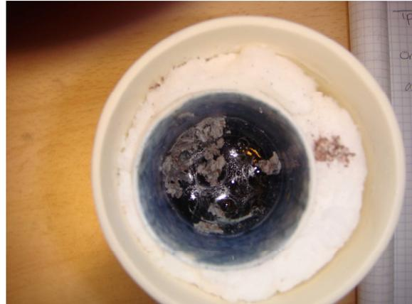
Figure IV-33 : Vue plongeante sur les creusets avec les résidus de biomasse sur le verre refroidi.
