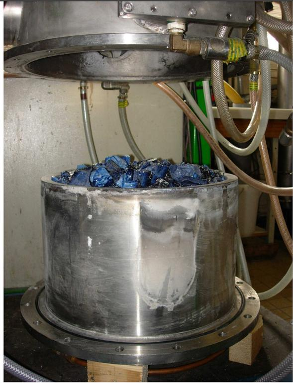
Figure III-10 : Photographie du creuset en acier contenant le verre à fondre.
