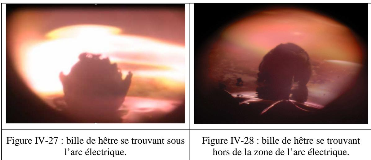
Ces observations semblent indiquer l'importance des sources d'énergies en fonction de la position de la bille dans le réacteur. Le plasma d'arc, qui chauffe l'atmosphère à une
