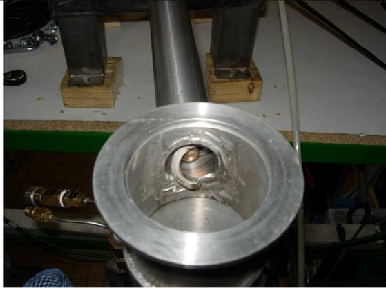
Figure III-19 : Fin de la vis d'Archimède où les éclats tombent dans le distributeur.
