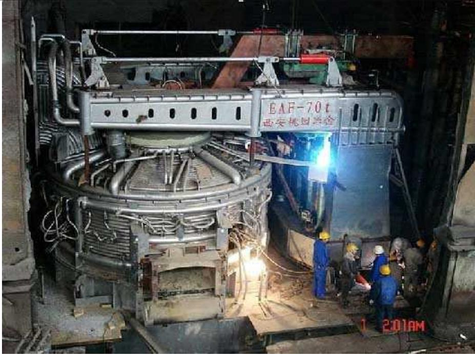
Figure VI-4 : Exemple d'un four à arc électrique de sidérurgie de type HX (ici HX 70) (par Xian Taoyuan Metallurgical Equipment Engineering Co., Ltd.) ([Alibaba, 2011](#)).
