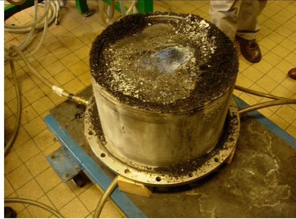
Figure IV-18 : Photographie du bain de verre à l'ouverture du four après l'essai N°4.
