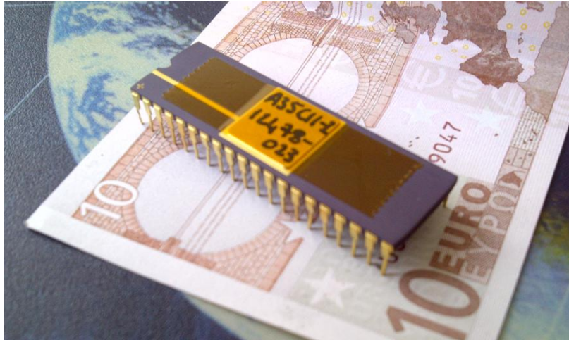
Figure IV- 6 : Circuit emballé dans un boîtier DIL40
