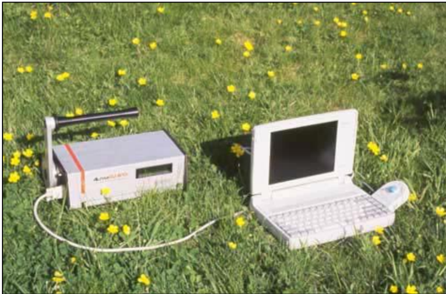
Figure I- 12 : La chambre d'ionisation Alphaguard
