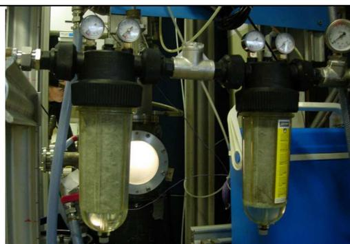
Figure II-8 : Les filtres dans la boucle en sortie de l'échangeur
