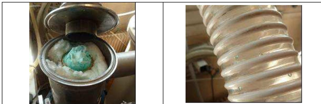
Figure III-22 : Etat du filtre en aval du cyclone
