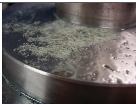
Figure III-37 : Poudres sur le fond du réacteur
