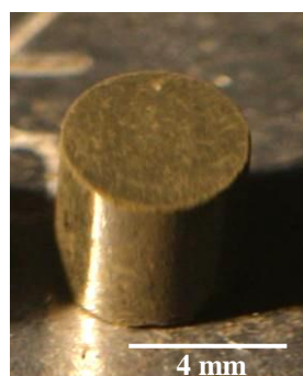
Figure 48 : Macrographie d'une pastille crue du mélange de poudres UO_2 - 45\% PuO_2 .
