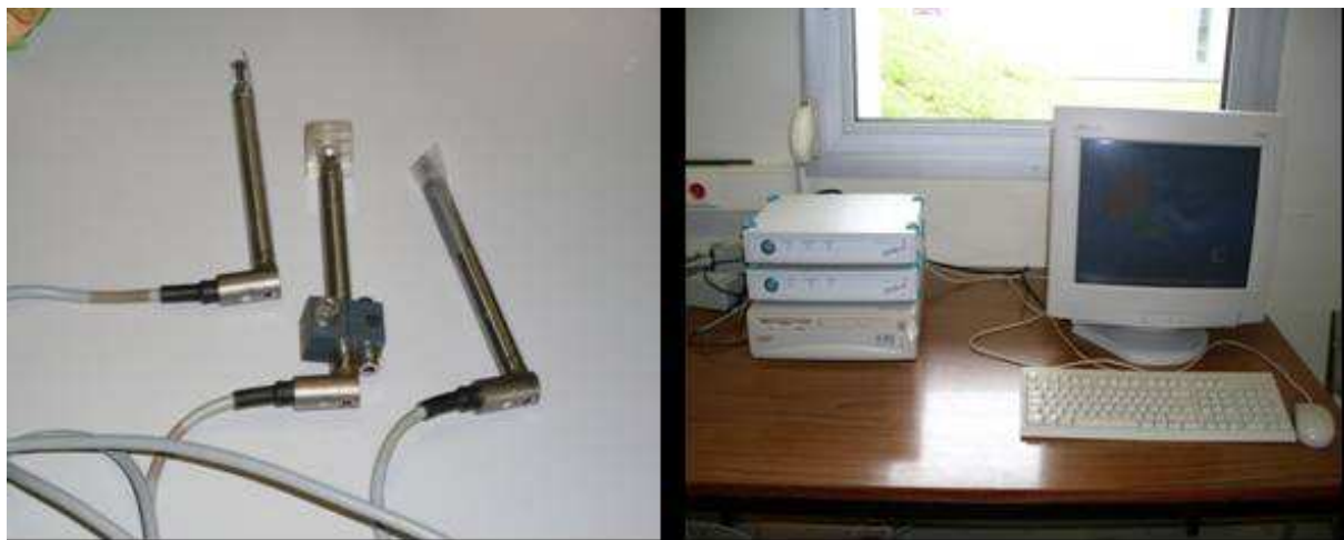
Figure I.2.11. Capteurs de déplacement et centrales d'acquisition
