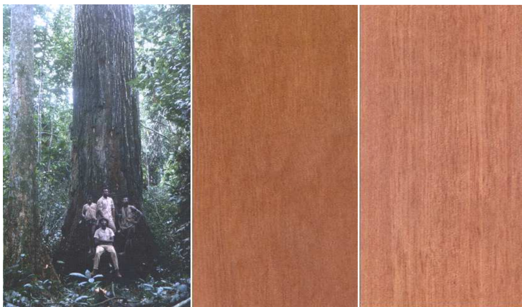
a. Sur pied (R. Letouzey) b. Coupe sur dosse et coupe sur quartier (CIRAD-Forêt)
