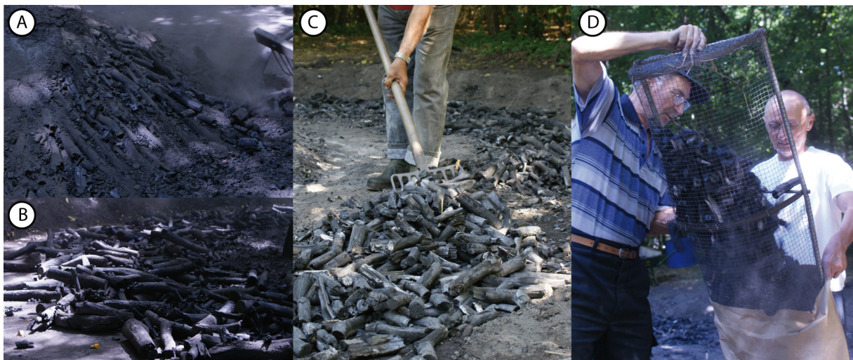
Figure 32 : Ouverture de la meule (A). Ramassage des charbons de bois (B, C, D) (Clichés S. Paradis-Grenouillet et R. Rouaud)
