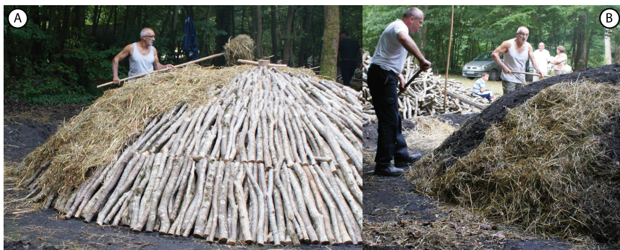
Figure 28 : Couvrir la meule avec de la paille (A) puis de la terre (B) (clichés S. Paradis-Grenouillet et R. Rouaud).
