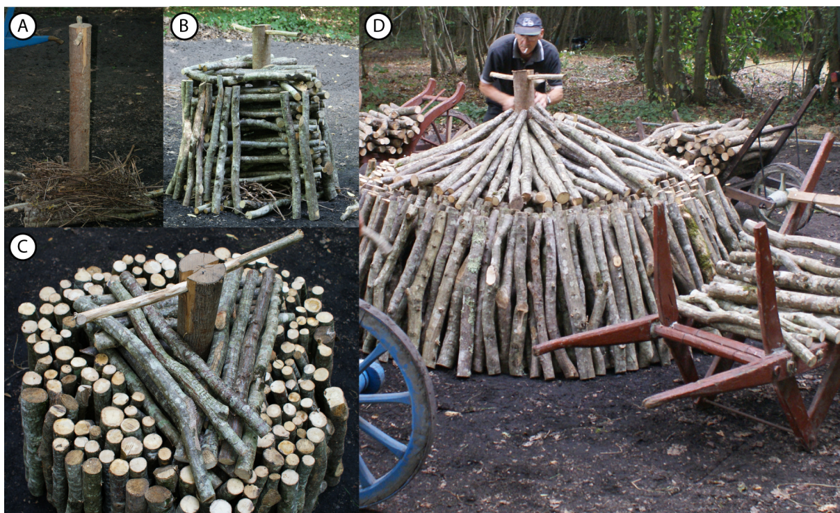
Figure 26 : Construction de la meule. (A, B) la cheminée centrale, (C,D) l'agencement des bois sur plusieurs étages (clichés S. Paradis-Grenouillet et R. Rouaud)
