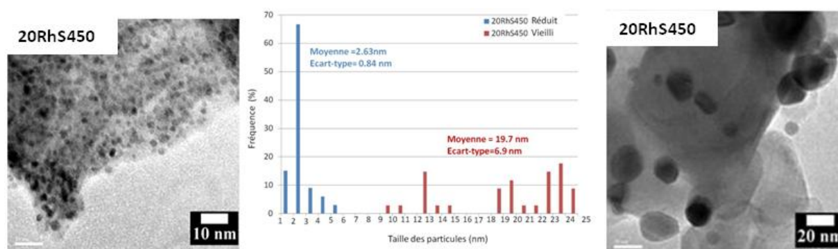
Figure 9 : Evolution de la population moyenne de taille des particules de Rh d'un catalyseur référence calciné à 450°C puis réduit (450°C 4h sous 3% H_2 /Ar) et après vieillissement (900°C H_2O/N_2 : 3/1 molaire pendant 5 jours).
