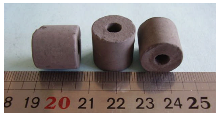
Figure 6 : Un catalyseur type pour le vaporeformage du gaz naturel, le catalyseur Süd Chemie G90B.
