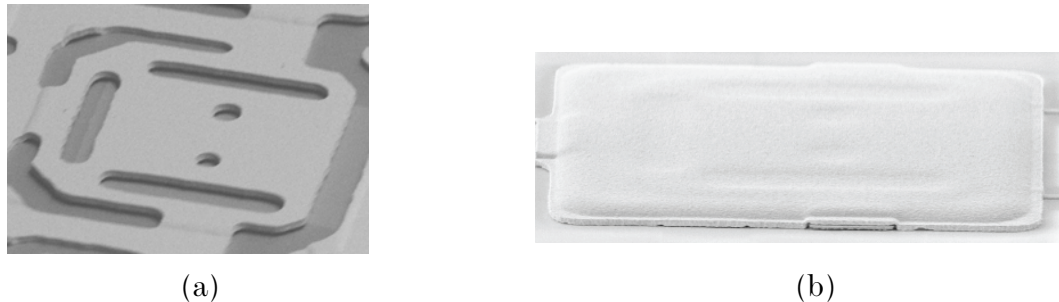
Fig 1.9 - Photographie au microscope à balayage électronique de la capacité commutée MEMS développée par Xlim (a) avant et (b) après encapsulation.
