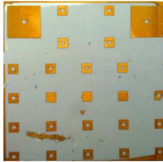
Figure II-38 : Vue de dessus d'un substrat d'une surface de 50x50 mm<sup>2</sup> avec différents motifs gravés.
