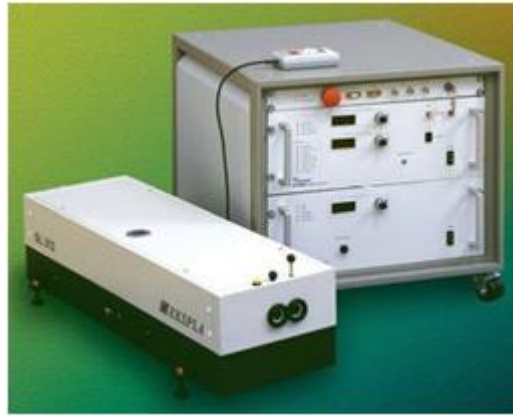
Figure II.9. Source laser nanoseconde avec son unité de refroidissement séparée
