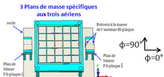
Figure IV. 24: Illustration de l'antenne hybride dans le cas où les plans de masse sont propres à chacun des trois aériens.
