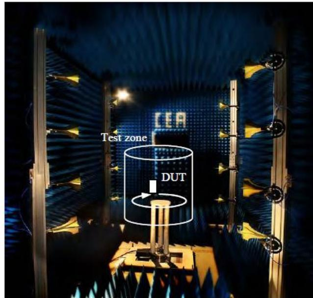
Figure I.27 : Système de test MIMO OTA dans la chambre anéchoïque LETI
