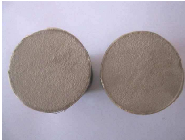
Figure E.2-7 : Rupture adhésive entre les deux couches de zircone. Couche supérieure réalisée avec un mélange de gaz Ar/H 2 et une température de préchauffage de la sous-couche de 200°C.
