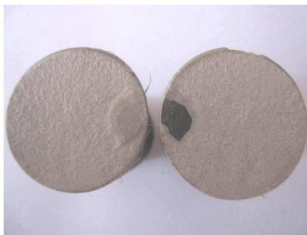
Figure E.3-6 : Rupture mixte entre les deux couches de zircone après vieillissement simulé dans un four à atmosphère contrôlée.
