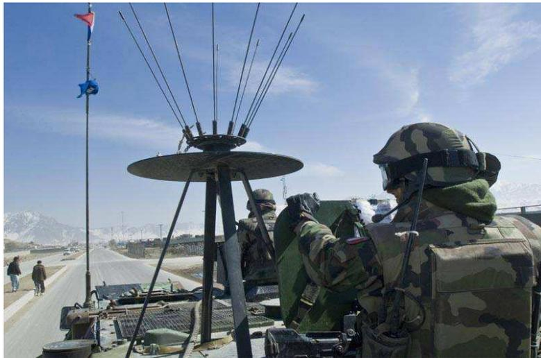
**Figure 7 : Brouilleur anti IED sur un véhicule protecteur**
