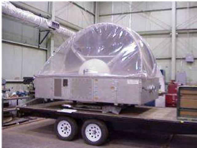
**Figure 39 : Exemple de source utilisant une seule antenne : JOLT développé par les US**
