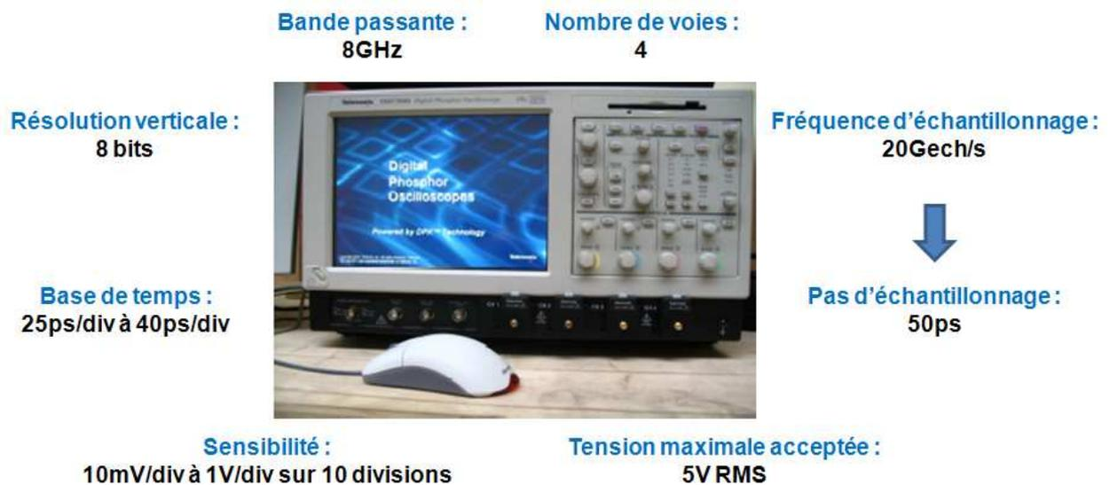
Figure 21 : Oscilloscope Tektronix TDS 6804B
