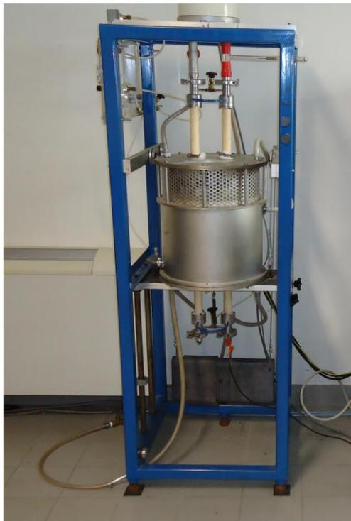
Figure 127 : Photographie de la Thermobalance utilisée pour l'analyse thermogravimétrique des nanoparticules synthétisées
