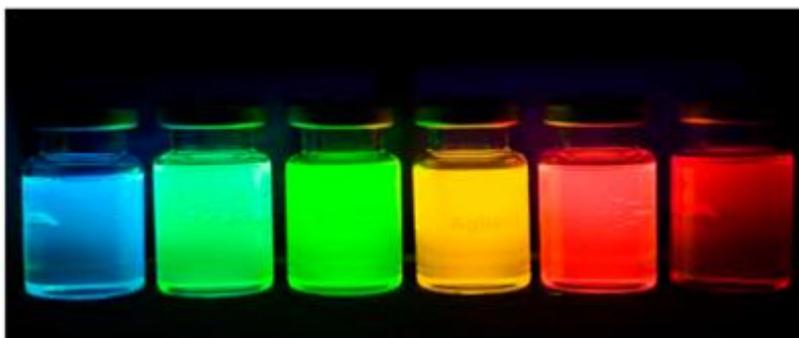
Figure 51 : Propriétés de fluorescence des nanoparticules de tailles comprises entre 2 et 10 nm
