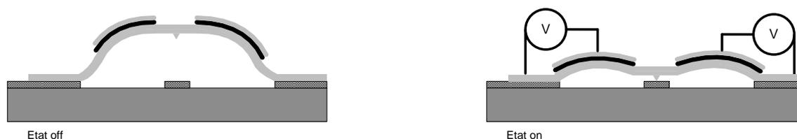
FIGURE 1.3 – Principe de l'actionnement piezoélectrique
