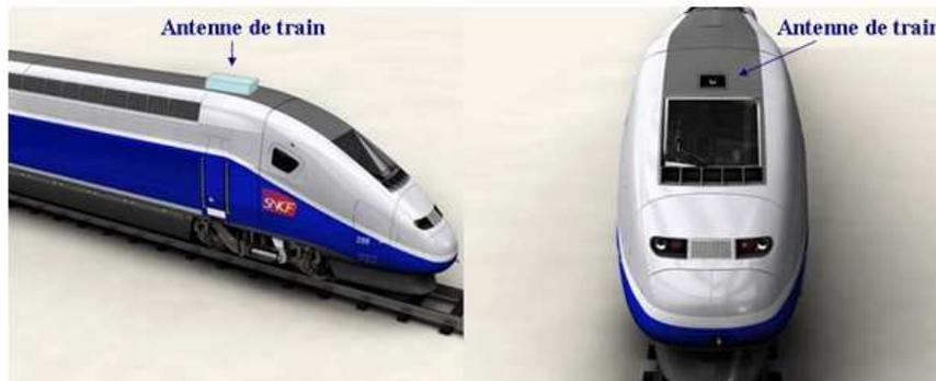
*Figure I.11 : Positionnement de l'antenne train*
