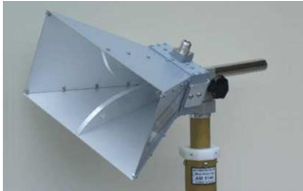
*Figure I.19 : Antenne cornet*
