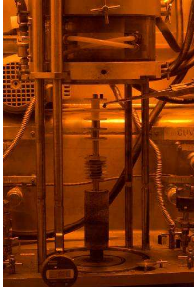
Figure 47 : four de frittage en cellule blindée.
